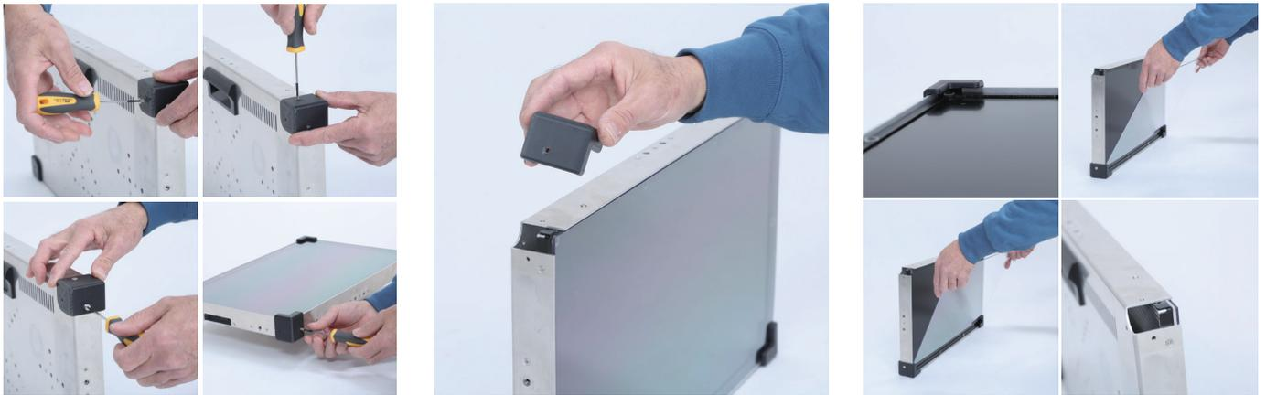
上部左右の ASA 樹脂を片側3本の シックスロブビスを T8 で外します。 ASA 樹脂を取り外します。
